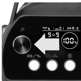
1. Obróć pokrętkę wyboru efektów oświetleniowych.
